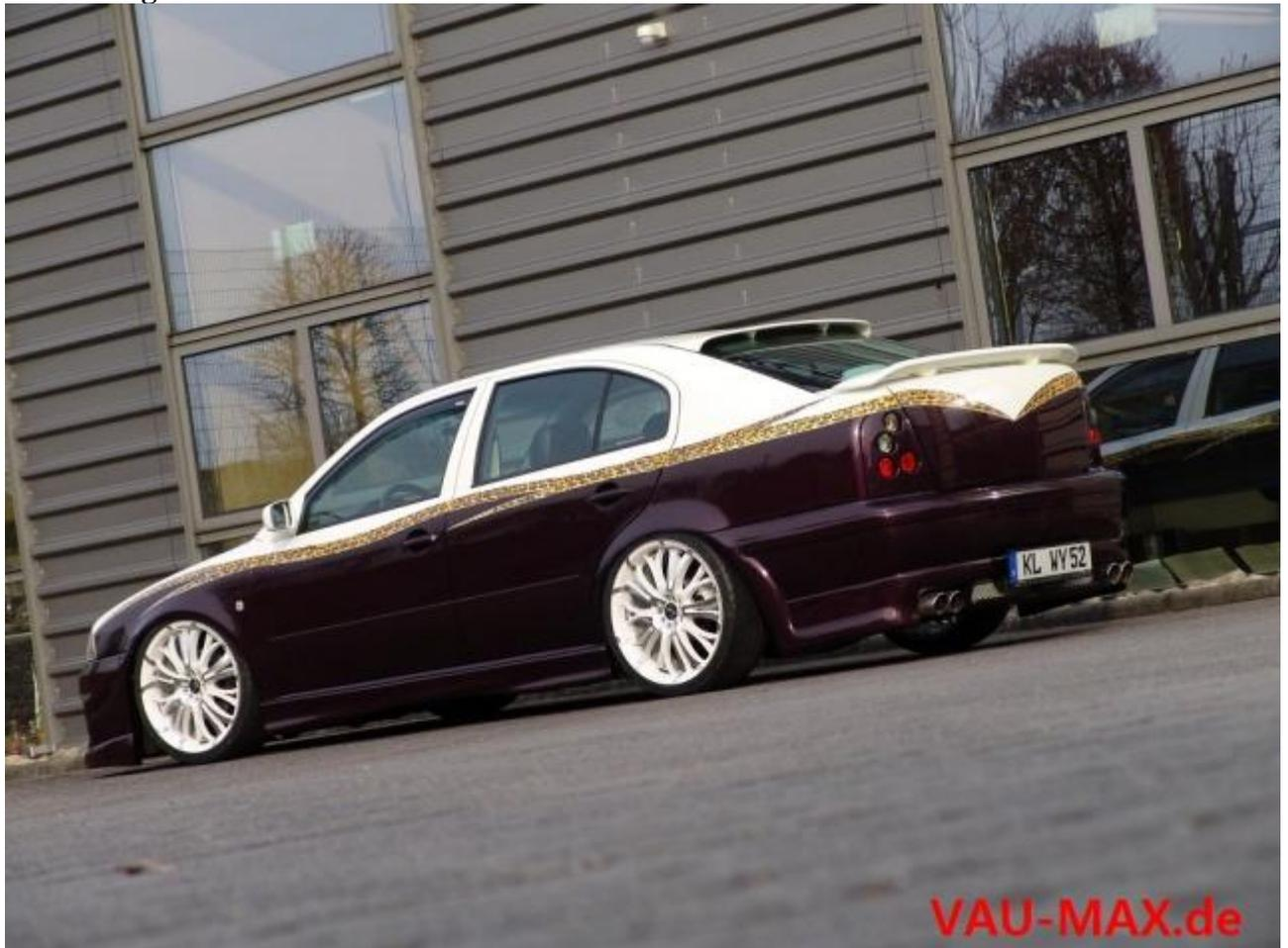
In Sachen Exterieur trumpft der Viertürer mit der aufwändig angepassten Frontschürze eines Honda Civic, Fox-Seitenschwellern und einer hinteren Stoßstange von Huthmann auf, die allerdings auf die nun verbaute Raid-HP-Duplex-Auspuffanlage angepasst werden musste.
